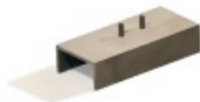
Bulones soldados desde el interior del Perfil
